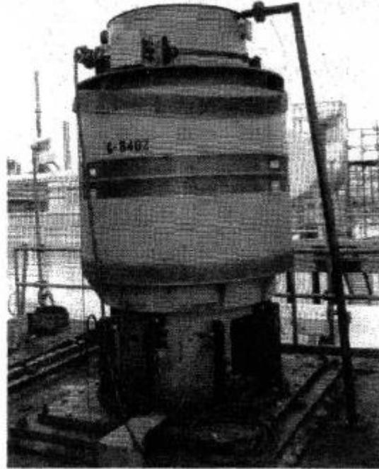
Fig.2 モータ上にマウントされた可変速シェーカー
