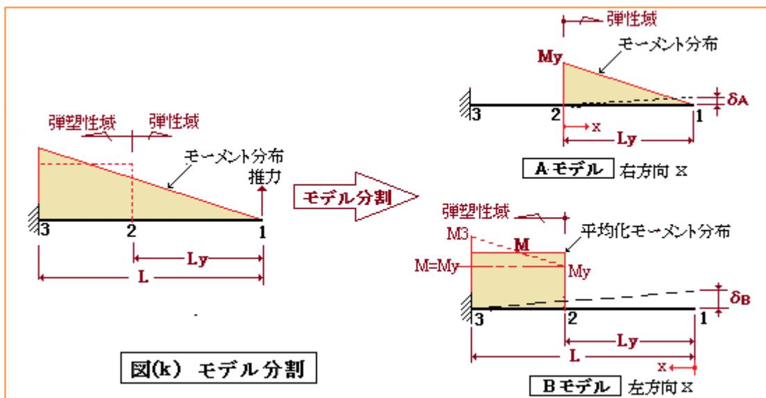
まずAモデルよりその先端撓み  $\delta_A$  を求める。後述のように  $(Y_3/Y_y) = K_R$  の関係があるのでこの場合の先端撓み  $\delta_A$  は次式で近似できる。
