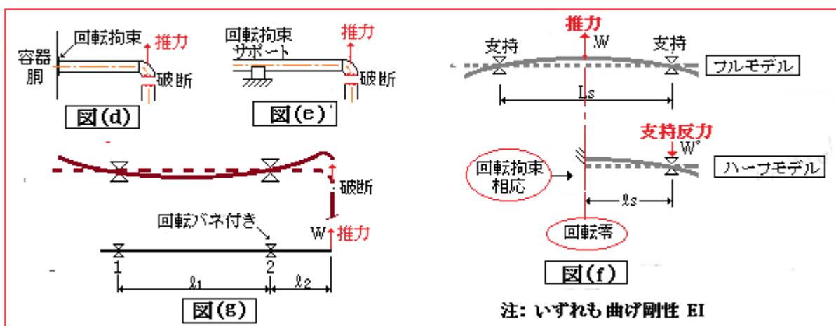
図(g)は破断パターンとして最も発生確率が高い。この場合、支持点2は固定端ではないのでカンチレバー構造とは云い難いが、支持点2には次のような回転バネ  $K_0$  が効いている。
