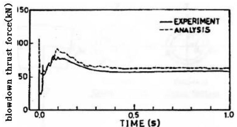
図(c) ブローダウン推力の変化(解析と実験の比較)
