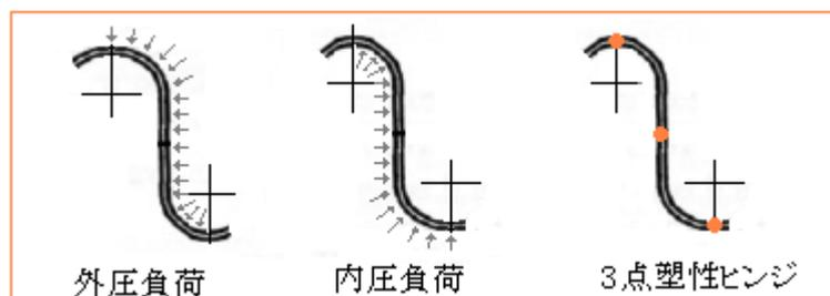
EJMA や ASME Sect.VIII では断面変形による円環座屈を対象にしているが、PNC はコンボの塑性不安定防止の観点から外圧座屈を考えている。故に PNC のいう外圧座屈は EJMA の面内座屈の範疇にはいる。
