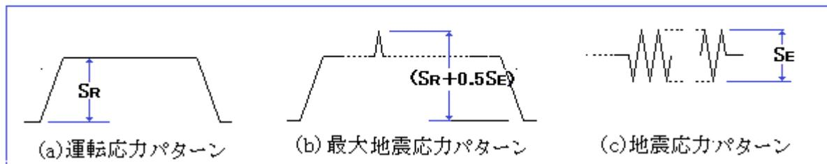
この図の3つのコード応力範囲  $S_R$ ,  $(S_R + 0.5S_E)$ ,  $S_E$ は、繰返し応力の規模を表わしているが、どれも公称的なもので、実際に配管構成要素や溶接部の局部に生じる応力範囲は、応力やひずみの集中によって拡幅されてもっとその範囲が広がる。この拡幅された応力範囲の1/2は応力振幅(片振幅) $S_a$ として疲労損傷評価の際の決定的なパラメータになる。 $S_a$ は次式で与えられる。
