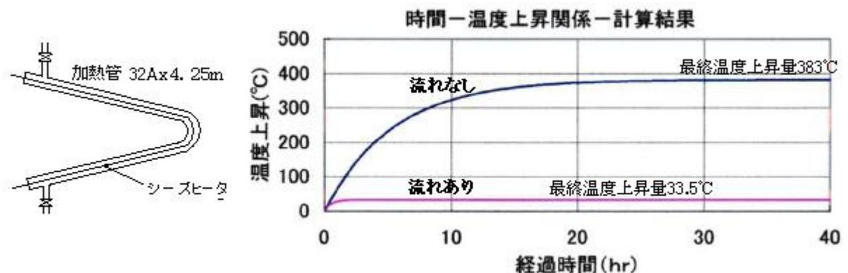
上昇量は  $383^\circ\text{C} / 33.5^\circ\text{C}$  で、管体温度はこれに  $30^\circ\text{C}$  を加えて  $413^\circ\text{C} / 63.5^\circ\text{C}$  になる。また温度は  $60\text{hr} / 15\text{hr}$  で最終温度に到達する。
