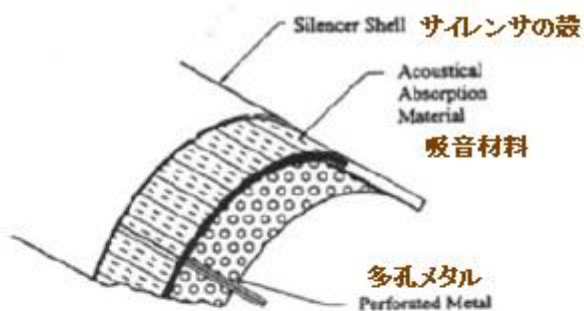
Fig.7 Internal Pipe Modification to Discourage Acoustic Cross-wall Mode Formation 壁交差モードの形成を妨害するためのパイプインターナル修正
