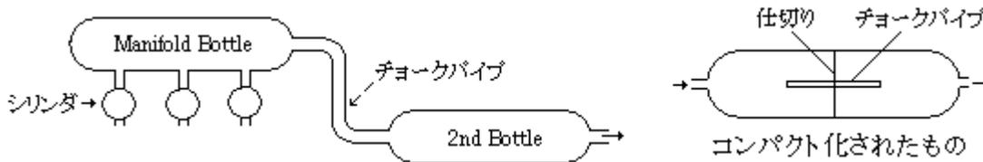
この単純な組み合わせは電気回路でいうローパスフィルタと機能的に似ているところからその中の代表的パターンを採って、 $\pi$ 形フィルタと呼ばれている。実際、電気回路のフィルタ同様に低周波成分を通過させ、高周波成分の通過を抑止する(詳しくは次項)。
