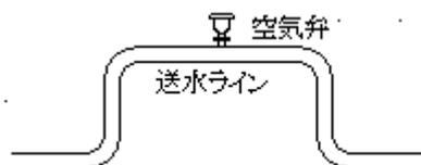
このような**空気弁の吸排気機能**は、**水撃対策**としても有効である。例えば送水ポンプのトリップによってライン圧力が負圧になったとき空気を吸い込んで水柱分離による水撃を回避し、更にその後で吸入した空気を排出して再起動時のトラブルを排除する。
