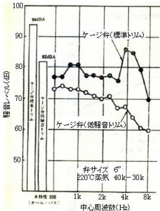
付図A3 スチーム圧力制御弁の騒音
